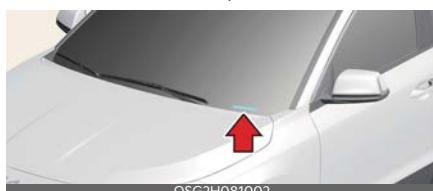
Transportlīdzekļa identifikācijas numurs (Vehicle Identification Number — VIN) ir numurs, kas tiek izmantots transportlīdzekļa reģistrēšanai, kā arī jebkādu juridisku jautājumu risināšanai saistībā ar īpašumtiesībām utt.
