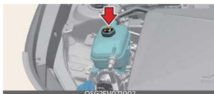
Pārbaudiet visu dzesēšanas sistēmas šķūtēju un sildītāja šķūtēju stāvokli un savienojumus. Nomainiet šķūtenes, kas ir piepūtušās vai nodilušas.
