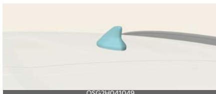
Haizivs spuras antena pārraida un saņem bezvadu signālus, tādus kā AM/FM, DAB, GNSS, LTE u.c.
