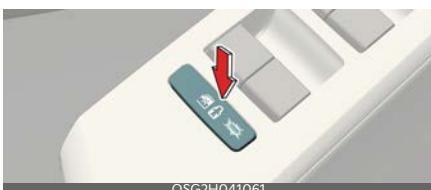
Kad elektroniskās bērnu drošības bloķēšanas poga ir pozīcijā "LOCK" (aizslēgts) un tiek konstatēts transportlīdzeklis, kas tuvojas no aizmugures, elektroniskās bērnu drošības bloķēšanas (为人) poga neatbloķēsies pat tad, ja vadītājs nospiež pogu, lai novērstu durvju atvēršanos.
