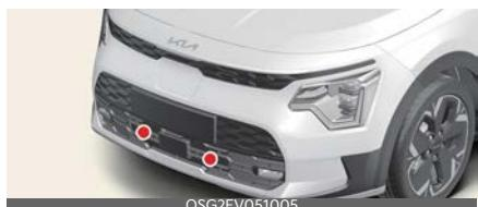
Aktīvā gaisa vārsta sistēma kontrolē gaisa vārstu zem priekšējā bufera, lai dzesētu transportlīdzekļa detaļas un uzlabotu energoefektivitāti.
