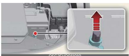
Ja uzlādes kabeli nav iespējams noņemt akumulatora izlādēšanās un elektrības vadu atteices dēļ, atveriet pārsegū un nedaudz pavelciet avārijas kabeli, kā norādīts iepriekš. Rezultātā uzlādes savienotājs tiks atbloķēts.
