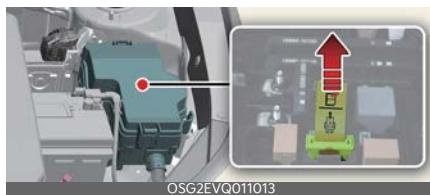
Ārkārtas gadījumā, lai atvienotu augstsprieguma akumulatoru, paveciet uz leju augstsprieguma atvienošanas slēdža dzelteno sviru.
