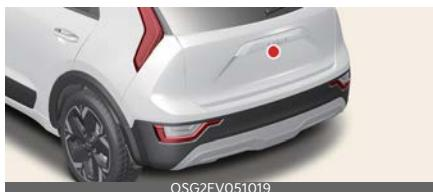
Platlenķa kameras tiek izmantotas kā atpazišanas sensori gājēju atpazišanai. Ja kameras lēcu sedz nepiederoši materiāli, piemēram, sniegs vai lietus, tas var negatīvi ietekmēt kameras veikspēju un stāvvietas sadursmes novēršanas palīgsistēma var nedarboties pareizi. Kameras lēcā vienmēr jābūt tīrai.
