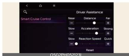
Lai iestatītu attālumu, paātrinājumu un reagēšanas ātrumu, dzinējam esot ieslēgtam, instrumentu panelī pieskarieties **Iestatījumi** → **Palīdzība vadītājam** → **Braukšanas ērtība** → **Viedā kruīza kontrole** vai instrumentu panelī pieskarieties **Iestatījumi** → **Automobilis** → **Palīdzība vadītājam** → **Braukšanas ērtība** → **Viedā kruīza kontrole**.
