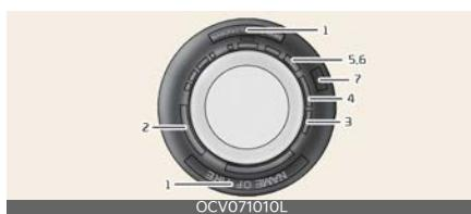
Šī informācija identificē un apraksta riepas galvenās īpašības, kā arī sniedz riepas identifikācijas numuru (TIN) drošības standartu sertificēšanas mērikiem. TIN var izmantot, lai identificētu riepu, ja tā tiek atsauktu.
