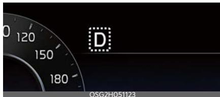
Kad EV poga atrodas ieslēgtā pozīcijā, indikators instrumentu panelī rāda pārnesuma pozīciju.
