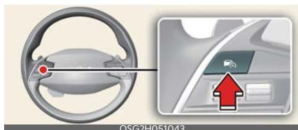
2. Nospiediet braukšanas palīdzības pogu pie vēlamā ātruma. Iestatītais ātrums un Kruīza (CRUISE) indikatora lampiņa parādīsies instrumentu panelī.
