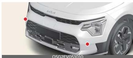
Priekšējā skata kamera un priekšējais radars, un priekšējie stūra radari (ja ir aprīkojumā) tiek izmantoti kā atpazīšanas sensors priekšā esošo automobiļu atpazīšanai.
