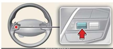
Nospiediet slēdzi (↔), lai īslaicīgi apturētu iestatīto ātruma ierobežojumu. lesatītais ātruma ierobežojums tiek izslēgts, taču ātruma ierobežojuma indikators (LIMIT) paliek ieslēgts.
