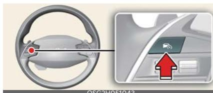
Nospiediet Braukšanas palīdzības (➡) pogu, lai izslēgtu manuālās ātruma ierobežošanas palīgsistēmu. Ātruma ierobežojuma (⌚ LIMIT) indikators izdzīsīs.
