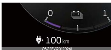
Attālums līdz akumulatora pilnīgai izlādei tiek rādīts atšķirīgi atkarībā no Braukšanas režima iebūvētajā vadības sistēmā atlasitā braukšanas režīma.
