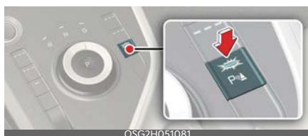
Nospiediet Drošības, novietojot automašīnu stāvēšanai, (P) pogu un turiet to nospiestu ilgāk par 2 sekundēm, lai ieslēgtu vai izslēgtu stāvvietas sadursmes novēršanas palīgsistēmu.
