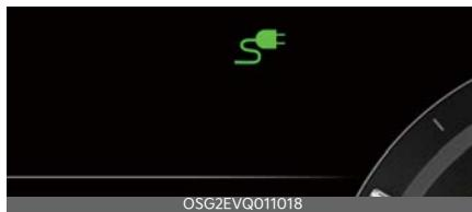
7. Pēc uzlādes sākšanas paredzamais uzlādes ilgums apmēram 1 minūti tiek parādīts instrumentu panelī. Arī tad, ja uzlādes laikā atvērsiet vadītāja sēdeklā durvis, prognozētais uzlādes laiks tiek apmēram 1 minūti parādīts instrumentu panelī.
