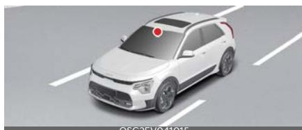
Priekšējā skata kamera tiek izmantota kā uztveršanas sensors, ar kuru braukšanas laikā atpazīst vides apgaismojumu un spilgtumu. Atpazīšanas sensora konkrēto atrašanās vietu skatiet iepriekšējā attēlā.
