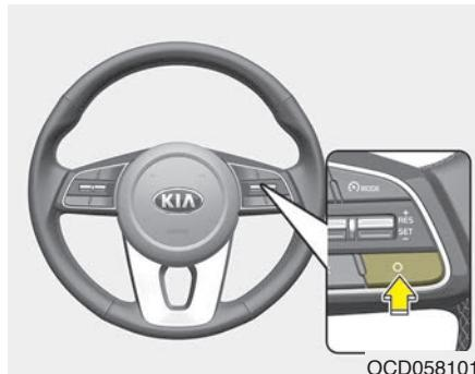
Katra no šīm darbībām atcels pastāvīgā ātruma uzturēšanas sistēmas darbību (pastāvīga ātruma uzturēšanas sistēmas indikators mērinstrumentu blokā nodzisīs), bet sistēma netiks izslēgta. Ja vēlaties atjaunot pastāvīga ātruma uzturēšanas sistēmas darbību, piespiediet slēdzi (pret RES+) uz stūres. Tiks atjaunots iepriekš iestatītais ātrums.
