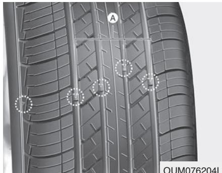
Ja riepas nodilst vienmērīgi, ar laiku parādās nodiluma indikators kā vien-gabala josla pār riepu. Tas nozīmē, ka atlikušais protektora augstums ir mazāks par 1,6 mm. Ja tā notiek, mainiet riepu.
