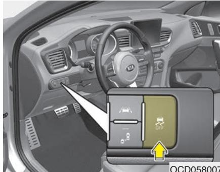
Elektroniskā stabilitātes kontrole (ESC) ir sistēma, kas stabilizē automobili līkumos. ESC kontrolē stūres darbību un faktisko automobiļa kustības virzienu.
