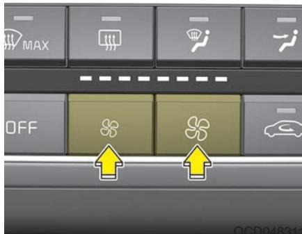
Ventilatora ātrumu var iestatīt vēlamajā līmenī, darbinot ventilatora ātruma regulatoru.
