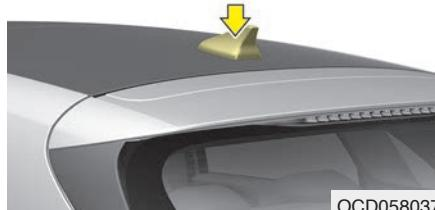
Jūsu automobilī tiek izmantota jumta antena, kas uztver AM un FM aprai-des signālus. Šī antena ir noņema-ma. Lai noņemtu antenu, grieziet to pretpulksteniski. Lai antenu uzstādī-tu, grieziet to pulksteniski.
