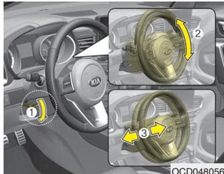
Lai mainītu stūres lenķi, velciet uz leju fiksatora atlaišanas sviru (1), regulējiet stūri vajadzīgajā lenķī (2) un augstumā (3, ja aprīkots), tad velciet fiksatora atlaišanas sviru augšup, lai fiksētu stūri vajadzīgajā stāvoklī. Stūres regulējumu vajadzīgajā stāvoklī veiciet pirms došanās ceļā.
