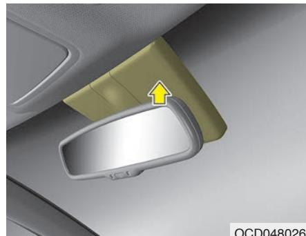
Automātiskā aizsvīduma notīrišana samazina iespēju vējstiklam aizsvīst no iekšpuses automātiski konstatējot mitrumu uz vējstikla iekšējās virsmas un gaisa plūsma virziena uz vējstiklu pastiprināties.
