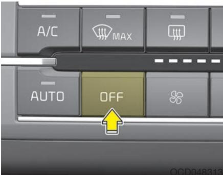
Pies piediet taustiņu OFF, lai izslēgtu pastāvīgas temperatūras uzturēšanas sistēmu. Tomēr, vēl aizvien var izmantot režīmu un gaisa ioplūdes taustiņus, kamēr aizdedzes slēdzis ir stāvoklī ON.
