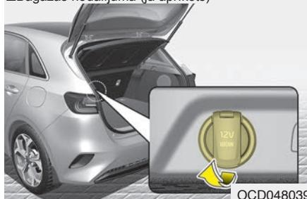
Strāvas izvads paredzēts mobilā tālrūņa uzlādēšanai vai citām ierīcēm, kas paredzētas darbināšanai no automobiļa elektrosistēmas. Ierīce nedrīkst patērt ne vairāk par 10 ampēriem.
