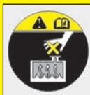
Nemēģiniet noņemt radiatora vāciņu motora dārbošanās laikā vai kamēr tas ir karsts. Verdošais dzesēšanas šķidrums un tvaiks var ar spiedienu izplūst un radīt smagus ievainojumus.
